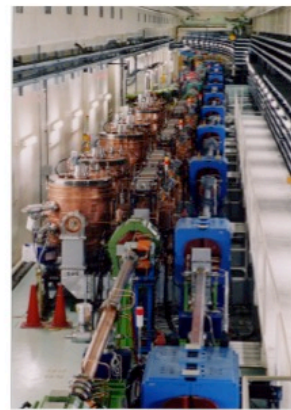
ビーム電流を高めるために高周波システムを増強
