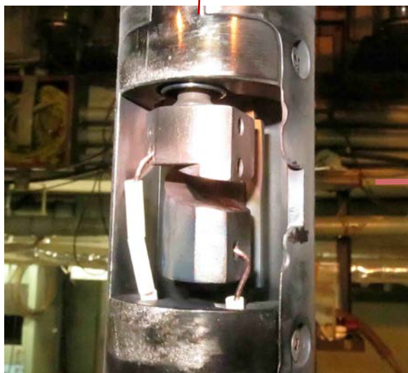
現在のスパイラルインフレクター電極に～4kV印加
