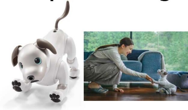
**画像認識** ソニーのエンタテインメントロボット“aibo”（アイボ）『ERS-1000』の画像認識にDeep Learningが使用されています。aiboの鼻先の魚眼レンズによる画像認識においての人物判定から顔トラッキング、充電台認識、一般物体認識などで積極的に活用され、多彩なセンサーを搭載することで状況に応じたふるまいの表出を可能にしています
