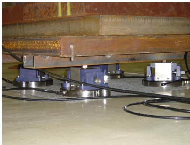
図6：研削した床面の上で浮上したレベリングブ ロック付きエアーパッド
