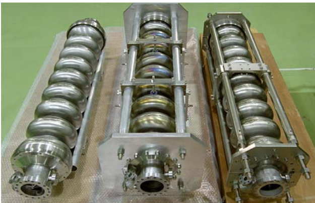
図1: STFベースライン超伝導空洞
