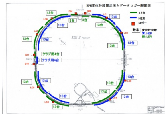
図9 KEKBリングと変位計配置
