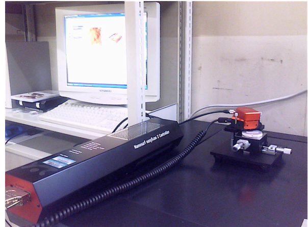
図2: AFM (easyScan 2 by Nanosurf AG) 右からスキャンヘッド、コントローラー、PCモニター
