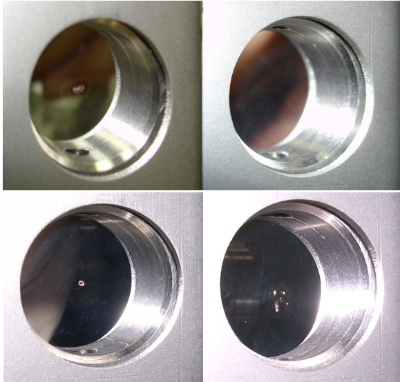
図 6. 顕著な性能劣化が生じていない現行 FEL ミラー（上）と過去に損傷を受けたミラー（下）の例との比較。ミラーマウントに取付けたまま撮影。それぞれ左が FEL 取り出し用結合孔のある上流側、右が下流側ミラー。
