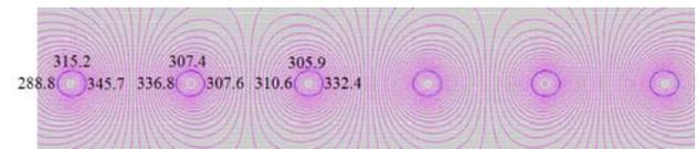
図 7-a Poisson による二次元磁場計算結果
