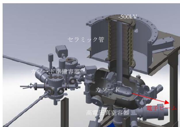
図1: 500-kV 光陰極DC電子銃
