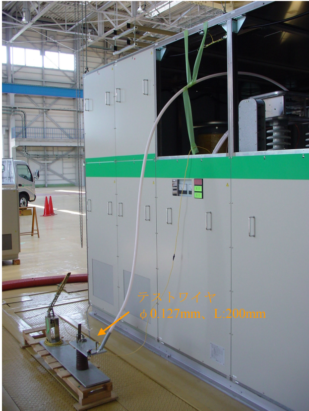
図6：負荷短絡試験
