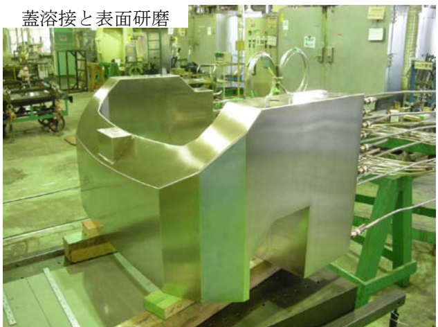
図 7 : K1.1D1 電磁石用斜め鞍型間接水冷 MIC コイルの製造過程の写真。
