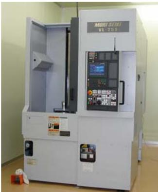
図 7 トリミング用 CNC 縦型旋盤の外観
