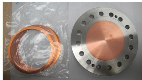
図 10: 銅ガスケットと銅/SUS フランジ
