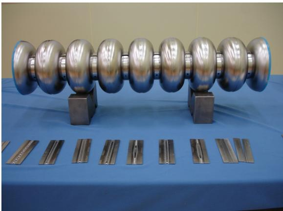
図7：完成した空洞センターセル部
