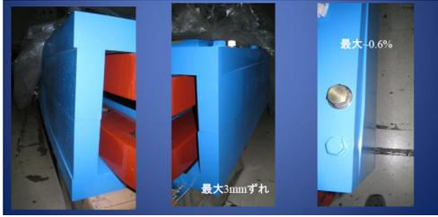
図 6: リターンヨーク合わせ面不一致及び切削問題最大で 3mm のずれと、-0.6%のヨーク切削
