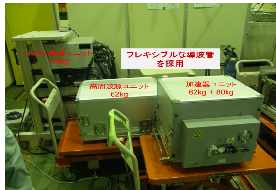
図2：3.95MeV X バンドライナックシステム
