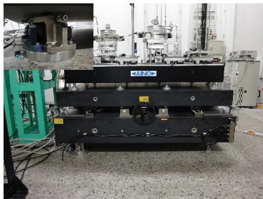
図 2: 重量 3.8t の石製汎用光学定盤。左上は脚部のエアパッド
