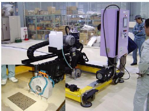
図 1: 床面研削装置。左下はダイヤモンドホイール部
