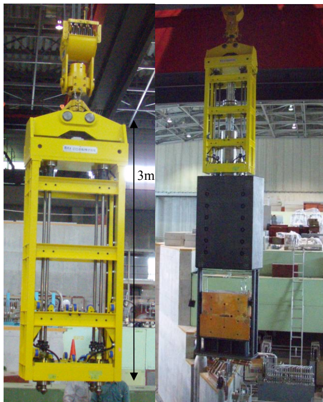
図2：第1コリメータ用ツイストロックと、それを用いて T1 第1コリメータを吊り上げている様子。
