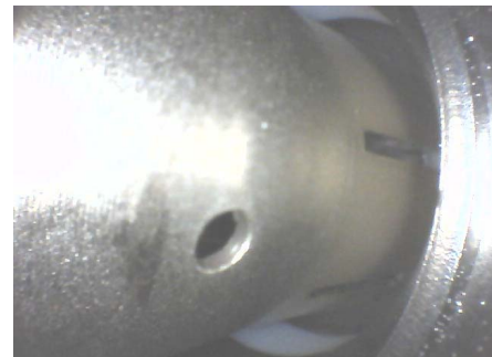
図3: スコープで電子銃カソードと同軸伝送路が接続部を確認。グリッド接続のスリ割り部と冷風循環用穴が確認できる。
