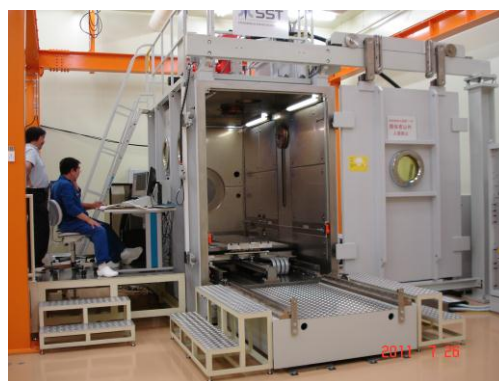
図 3 EBW マシンの外観 Steigerwald 社製高電圧 150 kV タイプ
