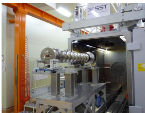
図6 エンドグループとセンターセル部をEBWする最終工程
