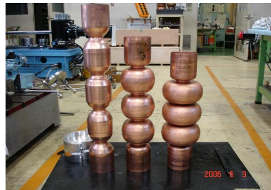
図11 試作したモデル空洞 左 ネッキング後 中央 中間液圧成形後、右 液圧成形完了
