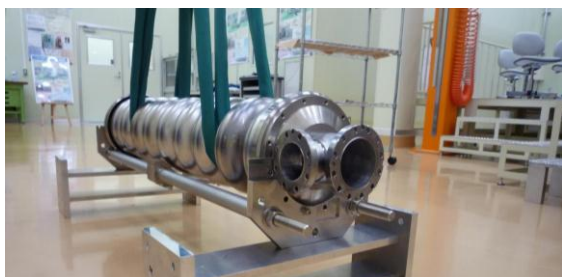
図7 完成した空洞
