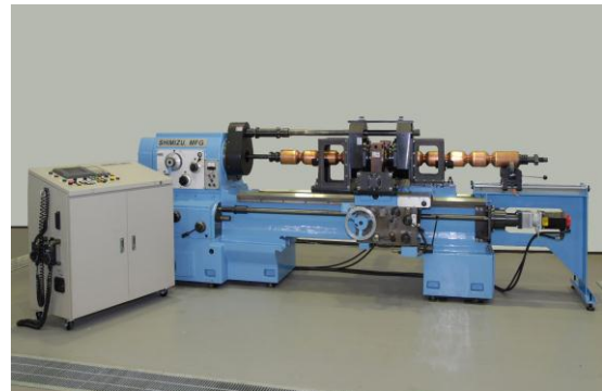
図10 9セル絞り加工が可能なネッキング加工機の外観
