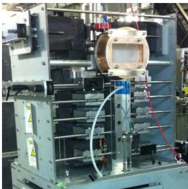
図3 クライストロン挿入前(上図)と挿入後(下図)の磁石位置。磁石を開けた状態でクライストロンを挿入し、その後閉じることで磁石をクライストロンに近づけられる。
