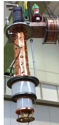
図4 パワーテストに使用したクライストロン (Toshiba E37501)
