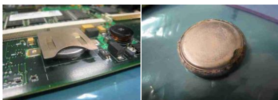
図 8 : ボタン電池液漏れ
